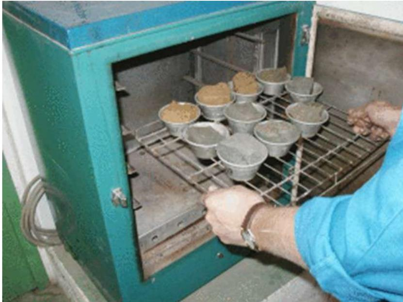
L'essai de teneur en eau permet de déterminer quel est le pourcentage massique (W%) d'eau dans le sol étudié, c'est-à-dire quelle est la masse d'eau présente par rapport à 100 grammes de sol sec.
