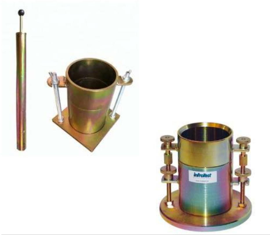
L'essai Proctor a pour but de déterminer la teneur en eau optimale, qui conduit à la force portante maximale, ce pour un sol donné et des conditions de compactages données.
